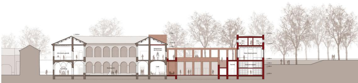
Abb. 7–9. Ansicht Südost (oben), Grundriss EG (Mitte), Schnitt A-A (unten) – jeweils in Rot: Neubau. Die Kolonnade liegt wie ein Schleier vor dem neuen, durch ein Café belebten Eingangshof. Joch- und Hofdimension entsprechen denen des Klosterinnenhofes, die Bautiefe des Archivriegels jener des angrenzenden Klosterbestandes. Eine schmale Treppe führt hinauf zu einem Umgang, welcher die *Piani Nobili* von
