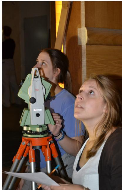
Abb. 6. Bauaufnahme des Servitenklosters im März 2012. Foto: Lehrstuhl für Baugeschichte, RWTH Aachen University.
