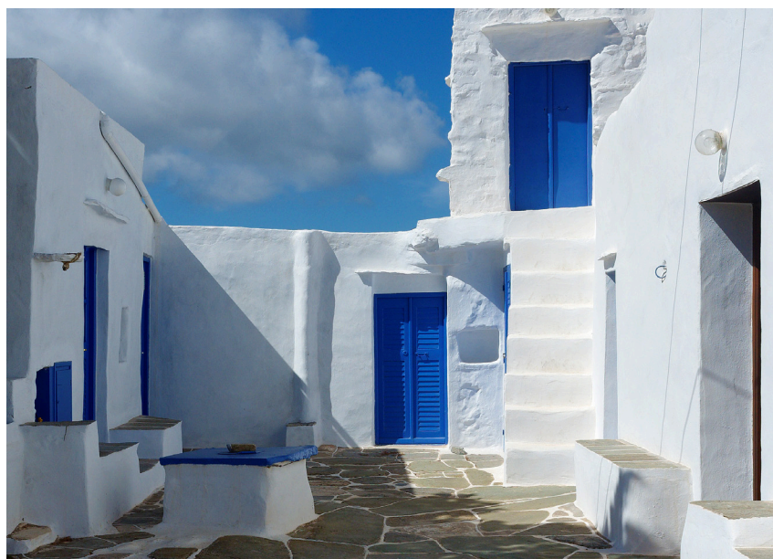
Abb. 9. Vernakuläre Architektur auf den Kykladeninseln in Griechenland. Der weiße Anstrich reflektiert die intensive Sonneneinstrahlung, die dichte Bauweise und Mauern schützen vor starken Winden und spenden Schatten. Kleine Fensteröffnungen schützen vor direkter Sonneneinstrahlung und regulieren Innentemperaturen. September 2013. Foto: Madras. Quelle: Wikimedia.
